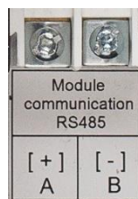
Widok złącza do podłączenia komunikacji RS485
